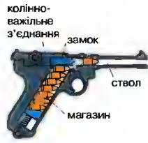
Пістолет Автоматичний пістолет Люгера 1900 року, прообраз пістолетів парабелум
